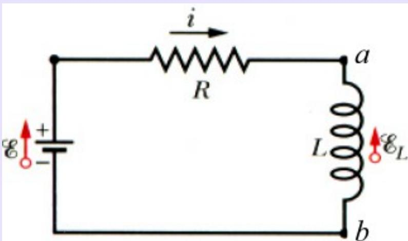
No circuito ao lado, uma fem induzida pelo indutor impede que a bateria imprima ao circuito uma corrente instantânea. Ou seja, a bateria deve efetuar trabalho contra o indutor para criar uma corrente. Parte da energia gasta pela bateria se dissipa no resistor por efeito joule, enquanto o restante da energia fica no indutor.
